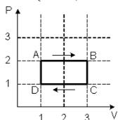
Если  $\Delta U$  – изменение внутренней энергии идеального газа,  $A$  – работа газа,  $Q$ - теплота, сообщаемая газу, то для процесса CD справедливы соотношения...
