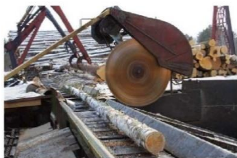
Раскряжевочные установки. Состав раскряжевочной установки ЛО-15А
