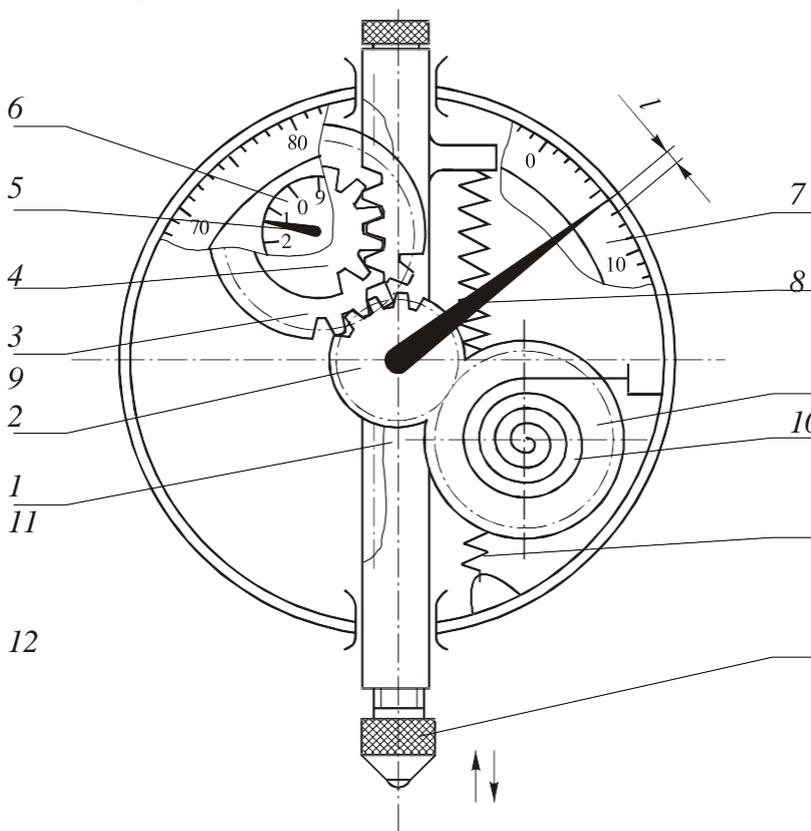
Принцип действия индикатора часового типа состоит в следующем (рис.1): Измерительный стержень 1
