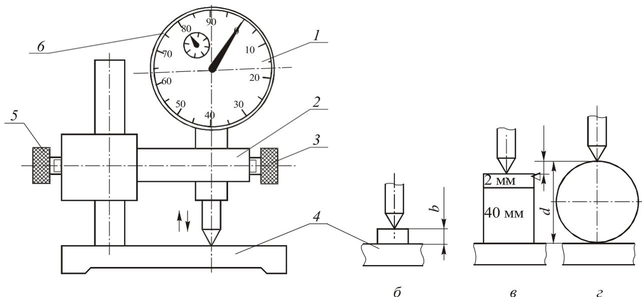
Рис.2. Измерение индикатором
