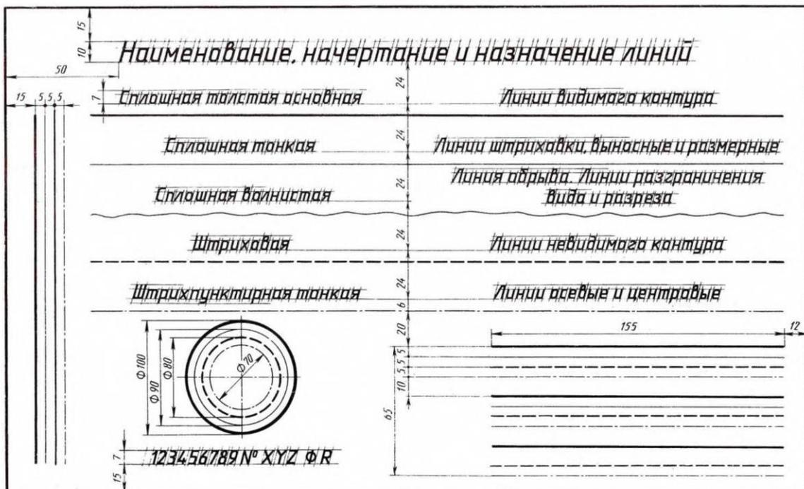
Выполнить графическую работу №1 в соответствии с данным изображением. Работу выполнять на листе формата *A4*, размеры не проставлять.
