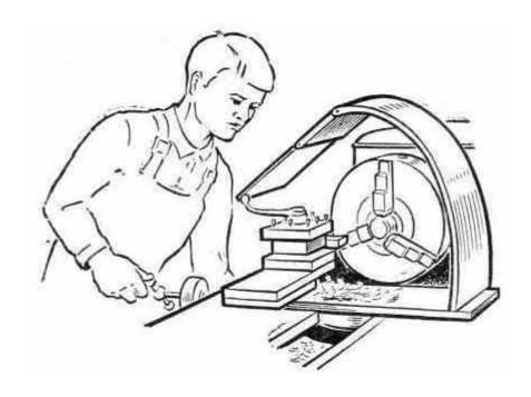
Особенно опасна сливная стружка, которая при обтачивании забивает резцедержатель, обматывает заготовку и делает невозможной дальнейшую обработку. Для получения дробленой стружки используют резцы со специальной заточкой передней поверхности резца или со стружколомателем.
