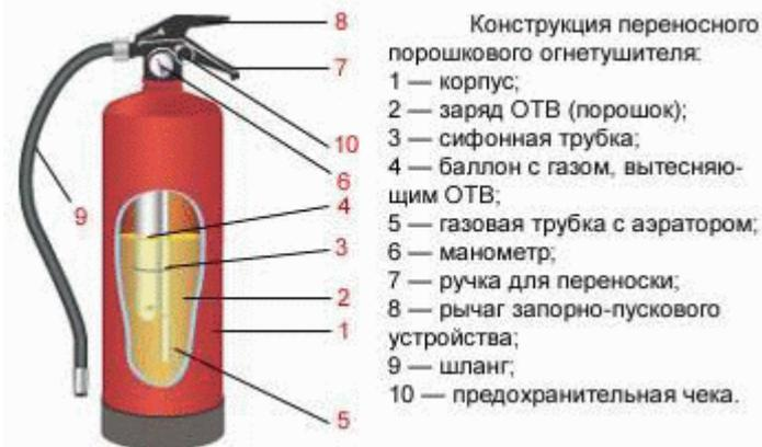
В качестве огнетушащего вещества используют порошки общего и специального назначения. Порошки общего назначения используют при тушении пожаров и загорании легковоспламеняющихся жидкостей (ЛВЖ) и горючих жидкостей (ГЖ), газов, древесины и других материалов на основе углерода. Порошки специального назначения применяют при ликвидации пожаров и загорании щелочных металлов (натрия, калия), органических соединений и других, способных к самовозгоранию веществ.
