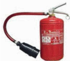
Воздушно-пенные огнетушители предназначены для тушения твердых и жидких веществ и материалов. В качестве заряда используют фторированные пленкообразующие пенообразователи. По принципу создания давления в их корпусе воздушно-пенные огнетушители подразделяются на: - закачные (з); - с баллоном высокого давления (б). По способу транспортирования к очагам пожара - на переносные (с полной массой до 20 кг) и передвижные (с полной массой до 400 кг).
