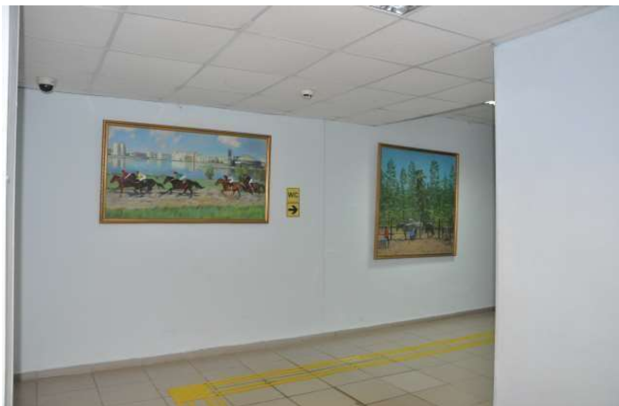
Указатели (стрелки-пиктограммы) размещаются на пути следования к санитарной комнате, чтобы человек мог заранее определить маршрут (рис. 16).
